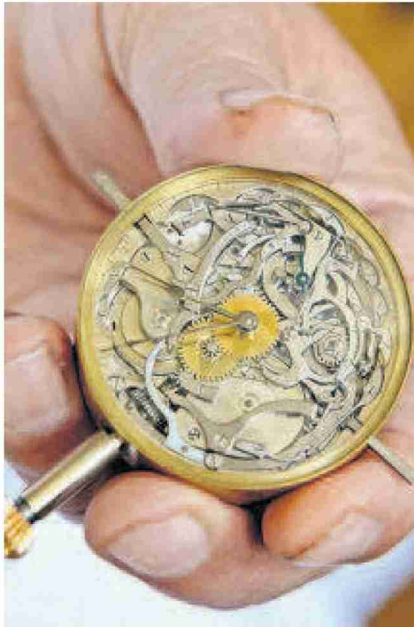
La première montre fabriquée par Philippe Dufour, une répétition minute, avant son emboîtage (à gauche). Ci-dessus, une partie des innombrables outils de l'horloger.
