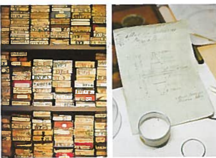
(左)100年以上前の部品が収められた箱がぎっしり詰まった収納棚。変色した箱が、ブランドの丁寧な時計作りの歴史を伝える。(右)0.06mmのネジでさえも再現して修理。その際には仕様書を記入する。また部品は必ず2つ製作し、1つは次の修理依頼に備えて保管するとか。
